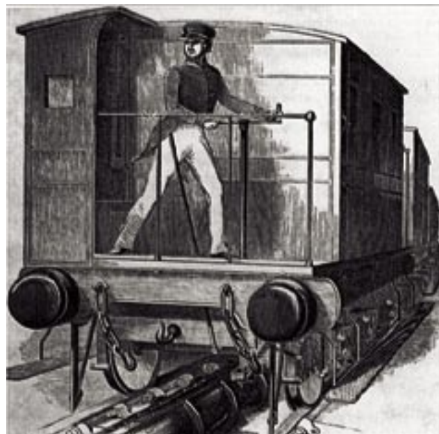
Maszynista na linii London–Croydon zakręca zawór uruchamiający hamulce. Aby zatrzymać pociąg musiał jeszcze inną dźwignią otworzyć przepust w tłoku by umożliwić swobodny przepływ strumienia powietrza.
